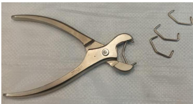
Figura 25. Pinza aplicadora de grampas metálicas
