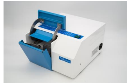
Figura 8. Herramienta conocido como “Stomacher” utilizada para determinar el nivel de infección con Nosema spp..
