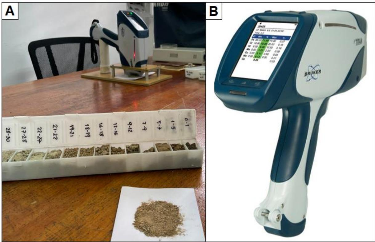
Figura 6.2. A) Analizador portátil de FRX S1 TITAN 600 Bruker® en funcionamiento. B) Imagen ilustrativa del equipo de FRX portátil.
