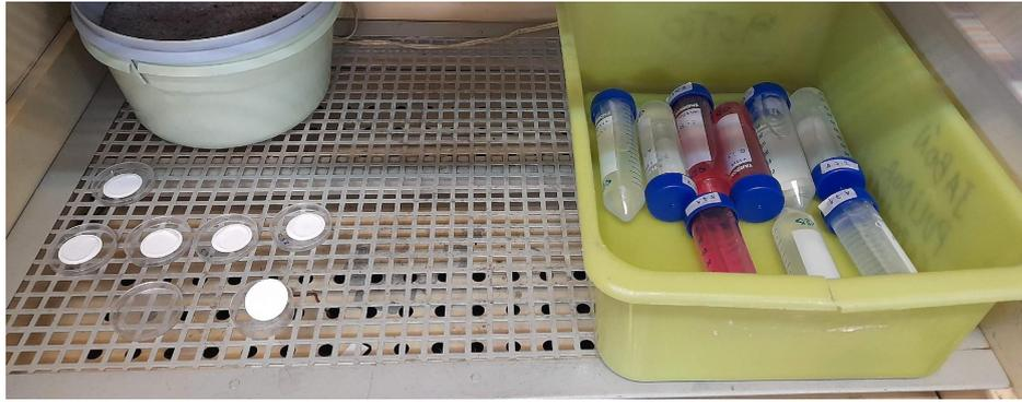
**Figura 14:** *Proceso de secado de las muestras luego de filtrado y sobre sus respectivos filtros (izquierda), y tubos en proceso de incubación (derecha), se colocan en posición horizontal para maximizar la superficie de interacción muestra – solución.*
