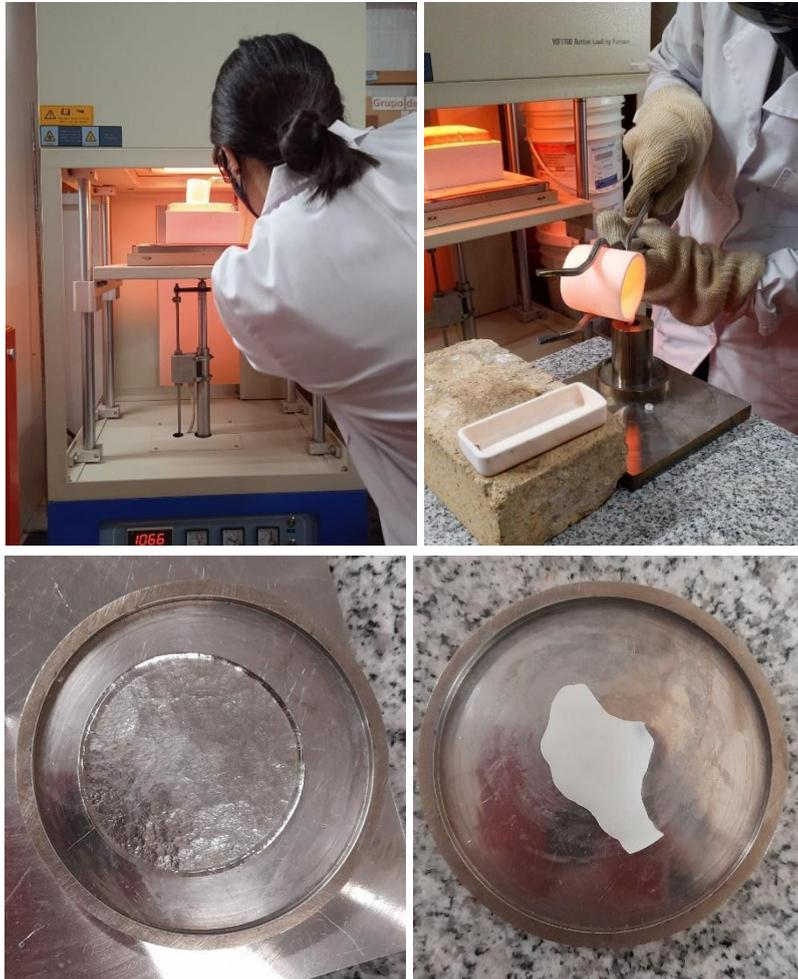
**Figura 15:** *Proceso de preparación de los BGs (arriba) y muestras obtenidas (abajo). La muestra izquierda corresponde a  $y = 0, x = 0$  y a la derecha a  $x = -2, y = -2$ .*
