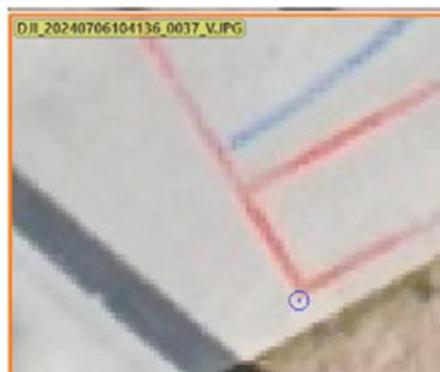
Imagen 29 - Punto de control en software Pix4D. Fuente: elaboración propia
