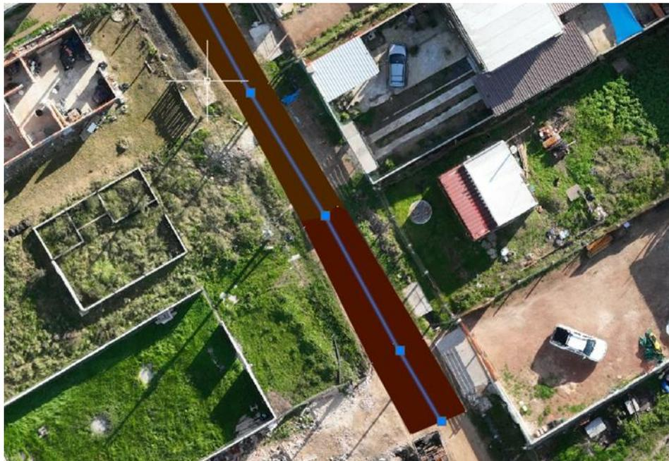
Imagen 31 - breakline creada en el eje del pavimento. Fuente: elaboración propia
