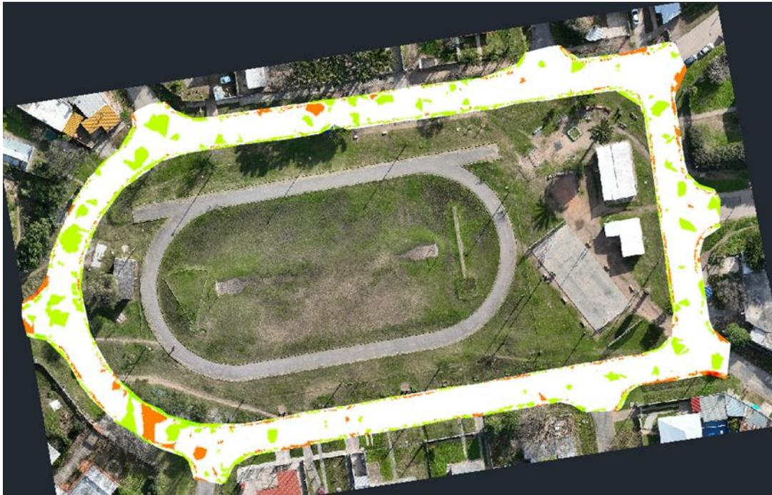
Imagen 39: comparación volumétrica Pegasus - LiDAR UAV en hormigón. Fuente: elaboración propia.
