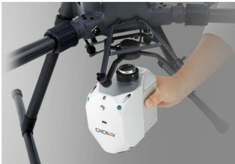
Imagen 13: Sensor conectado al Matrice 300 RTK. Fuente: chcnave.com
