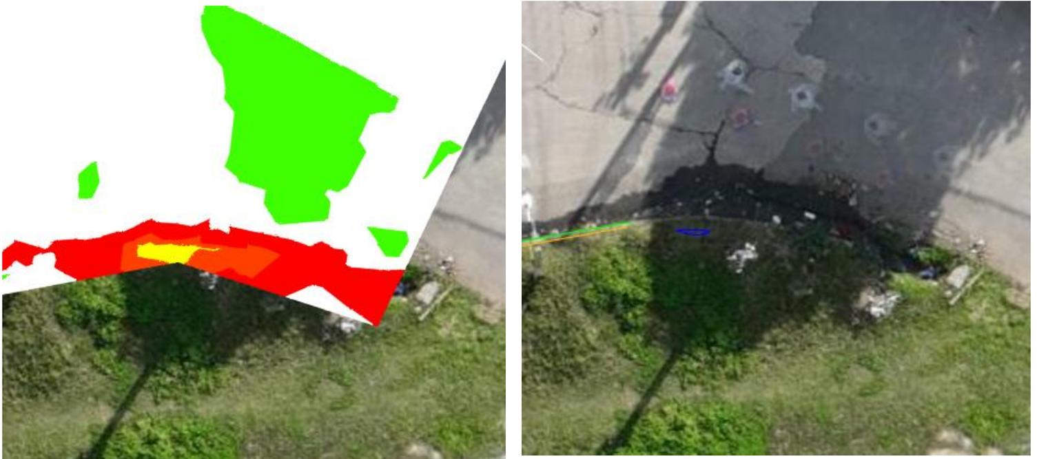
Imagen 50: Zona de máximas diferencias altimétricas entre el relevamiento realizado con el Pegasus y UAV RGB. Fuente: elaboración propia.
