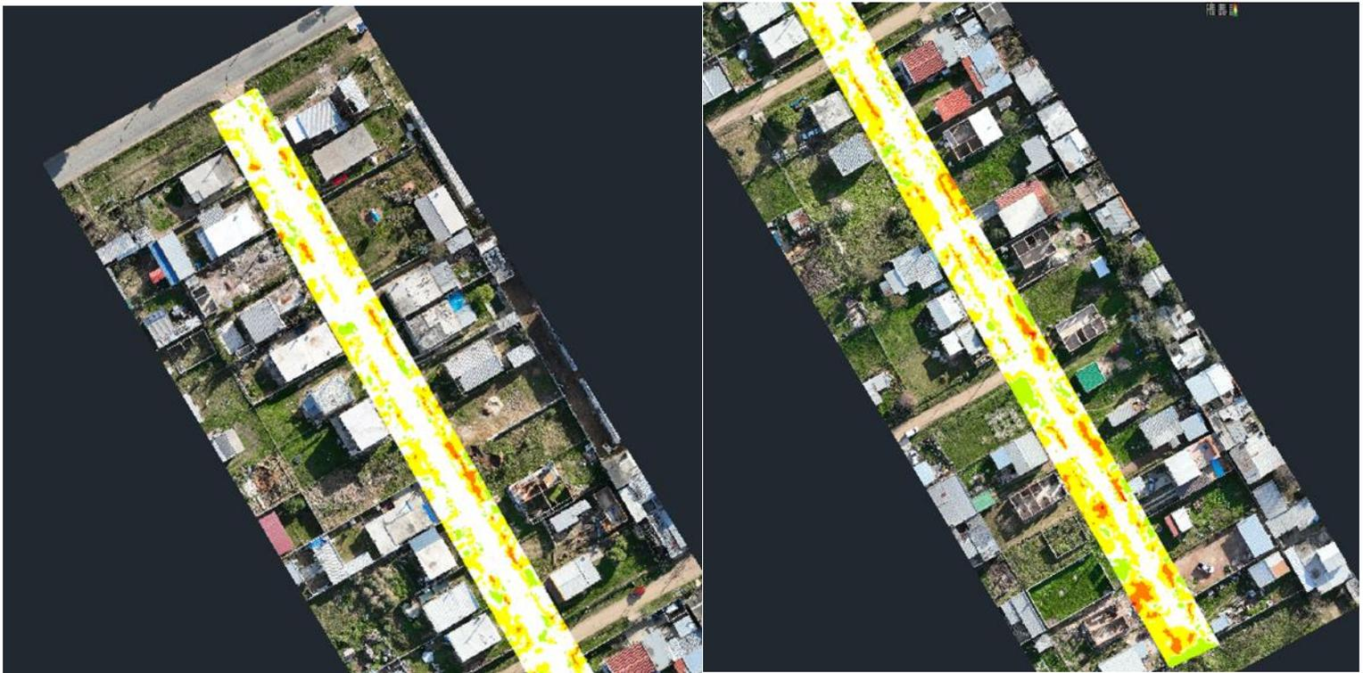
Imagen 47: comparación volumétrica Pegasus - RGB UAV en balasto. Fuente: elaboración propia.
