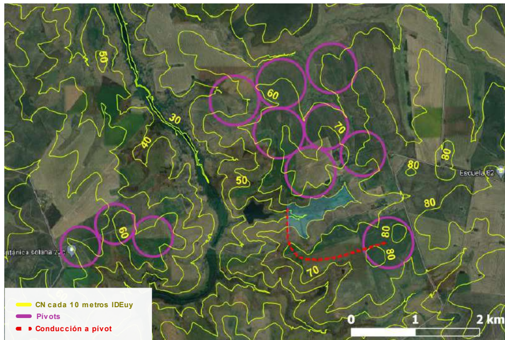
Figura 15-96: Esquema de conducción desde obra de toma a pivot de a mayor elevación geométrica.
