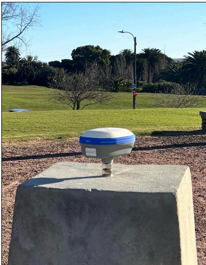
Figura 4.38. Ajuste de la antena sobre el mojón.
