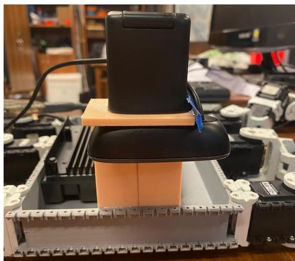
Figura 3.14: Robot con la cámara integrada
