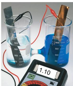
Figura 2.3: Celda Zn-Cu de laboratorio con separador de vidrio. [4]
