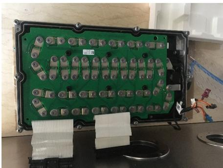
(c) Batería de Litio NMC de un HEV Mercedes-Benz
