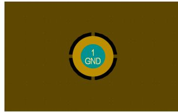
(b) Conexión de un pad a tierra con *thermal relief*.
