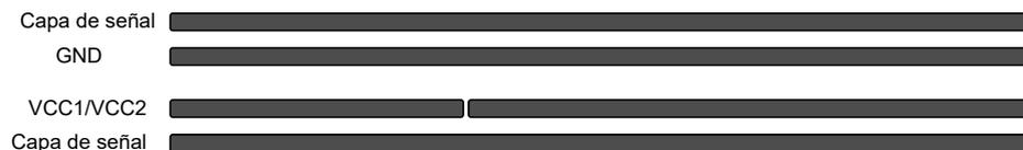
Figura 6.4: Disposición de las capas de la PCB.
