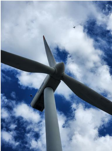
Figura 2.13: Dron inspeccionando una de las aspas del aerogenerador.
