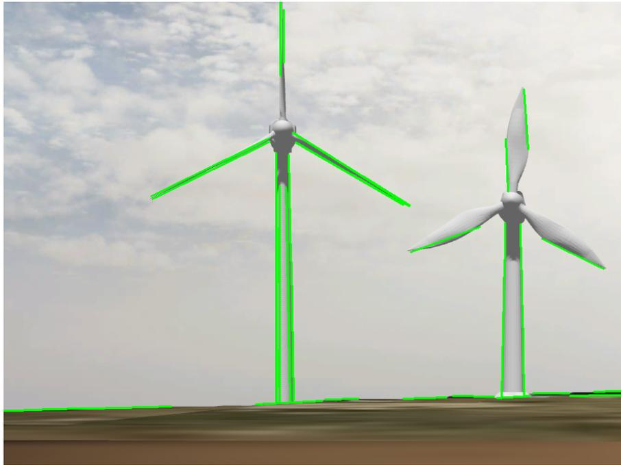
Figura 3.12: Detección de líneas utilizando la transformada de Hough en dos modelos distintos de aerogeneradores.
