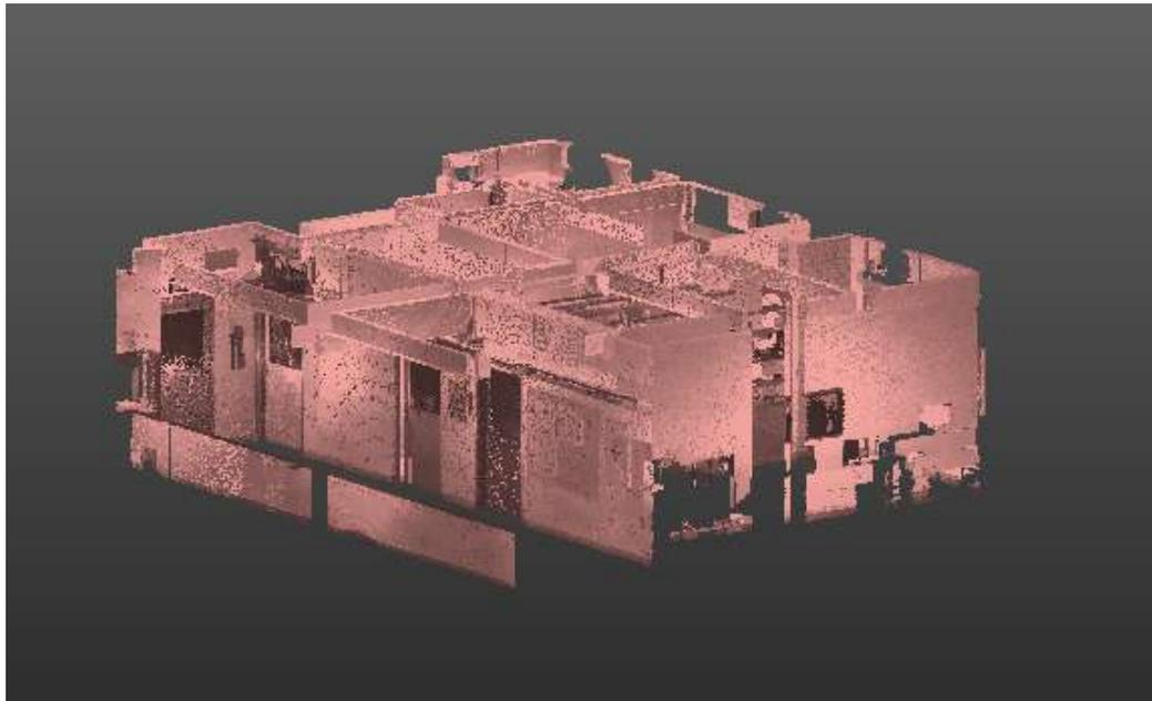
Figura 26: Clasificación automática como paredes en Trimble Realworks. Fuente: Creación propia.
