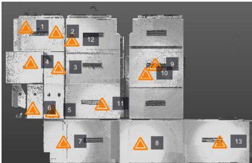
Figura 13: Posiciones de las estaciones de escáner láser Trimble X7.
