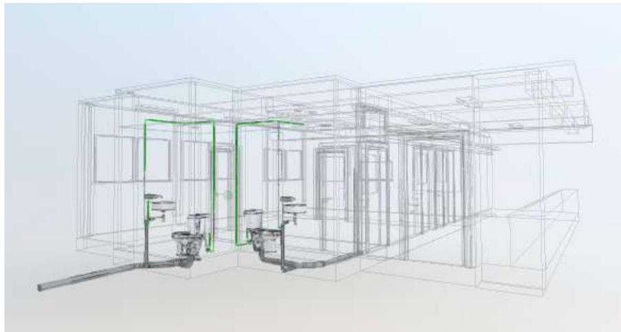
Figura 42: Vista de artefactos y tubería sanitaria . Fuente: Creación propia.
