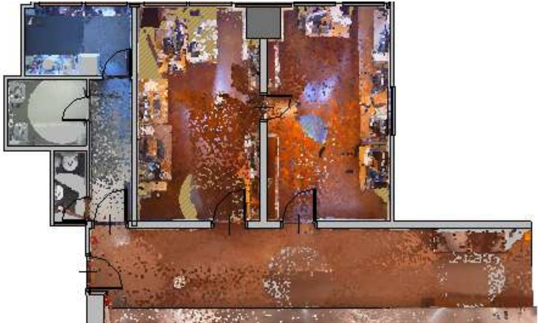
Figura 30: Vista de planimetría, con muros, aberturas y la nube de puntos. Fuente: Creación propia.
