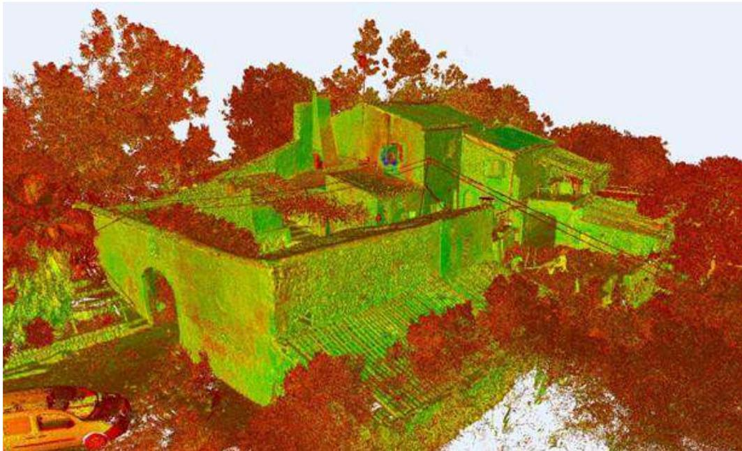
Figura 7 : Ejemplo de nube de puntos tomada con lidar, Fuente: Grupo Trato
