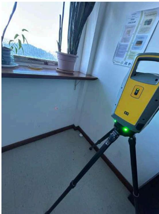
Figura 18: Captura de punto de referencia con escáner. Fuente: Creación propia.
