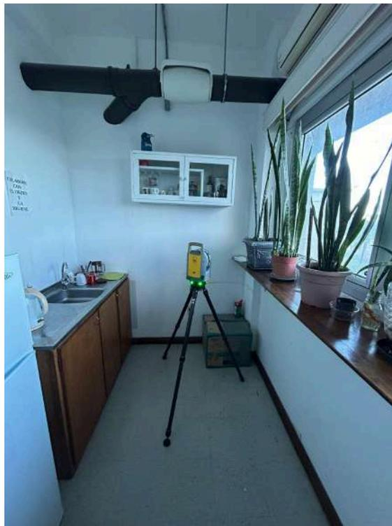
Figura 14: Proceso de escaneado, estacionado y captura de puntos con lidar. Fuente:
