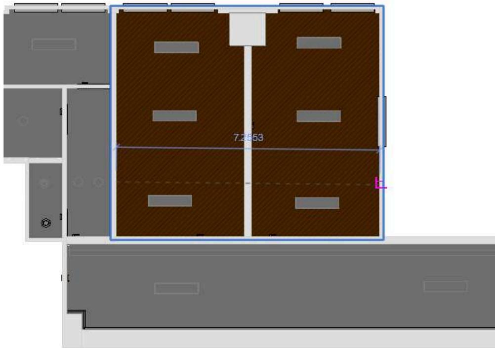
Figura 48: Medidas de deslindes en el modelo para comparar con plano y medida con distanciometro en sitio. Fuente: Creación propia.
