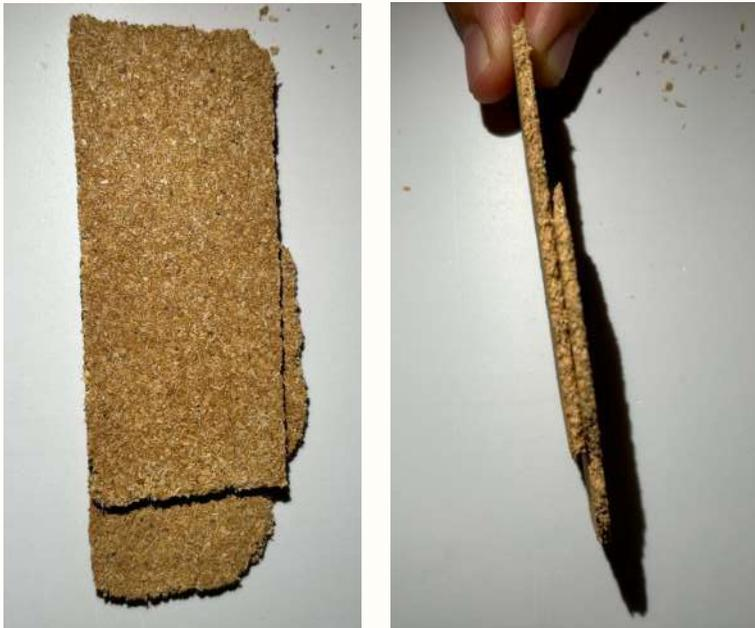
**Lijado:** se sometió una muestra de sección irregular a la lijadora para observar su comportamiento. Se puede observar como la muestra se desbasta con facilidad y logra una sección recta.
