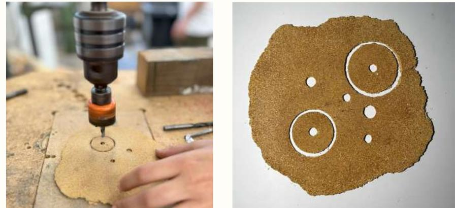
**Cortado:** se realizaron distintos tipos de corte al material con sierra, tijera y sierra. El método más adecuado para que el material no se quiebre ni desgrane es la sierra sin fin de banco o la trincheta si se tiene mucha precisión, por otro lado, la tijera aplica mucha presión sobre el material y además de cortarlo con cierta dificultad, lo quiebra.
