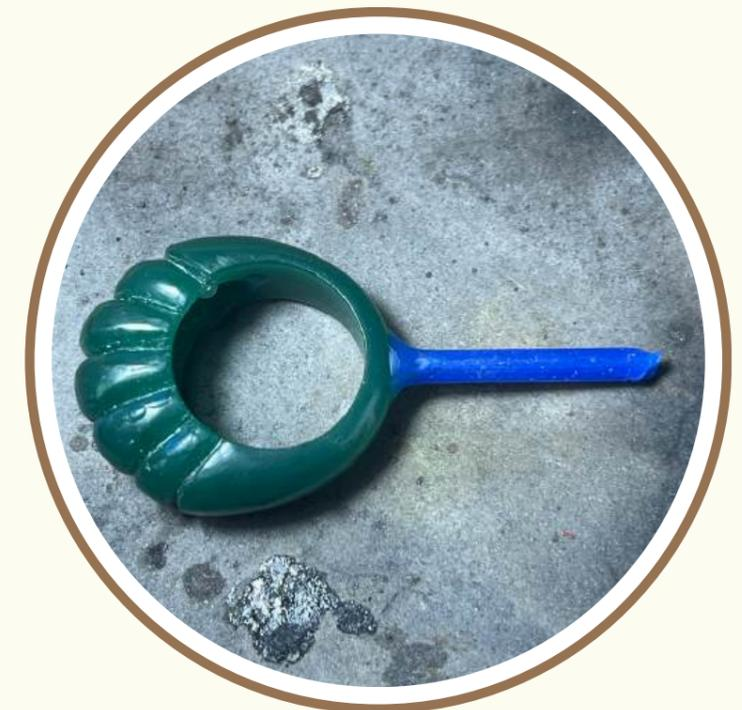
Colocar alimentadores / Pieza lista para fundición.
