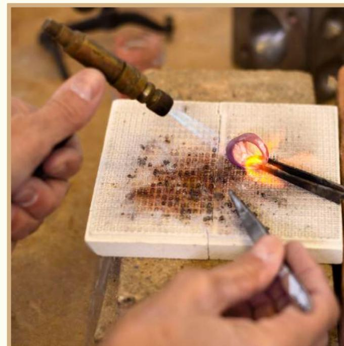
Figura 20. Vista superior del proceso de union de piezas en un anillo. (Imagen de Freepik)
