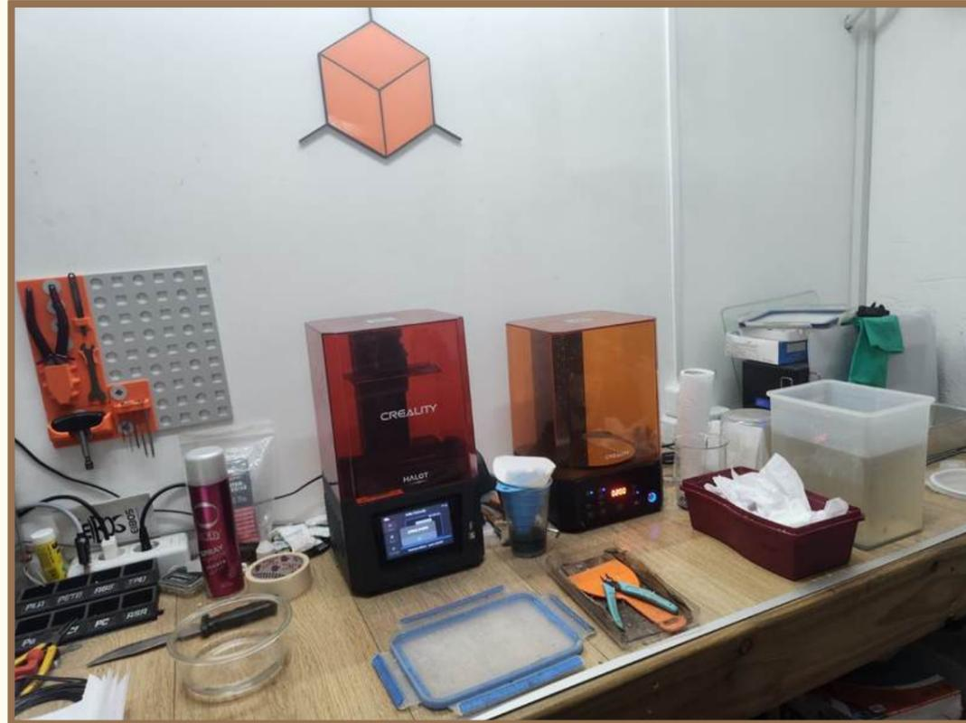
Antes de imprimir se debe acondicionar el área de impresión, manteniendo la impresora en una superficie estable. También se tiene a mano el alcohol isopropílico y las herramientas a utilizar.
