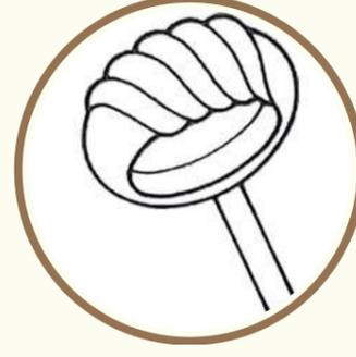
Se agregan canales de alimentación de cera y conductos de ventilación para realizar la fundición.
