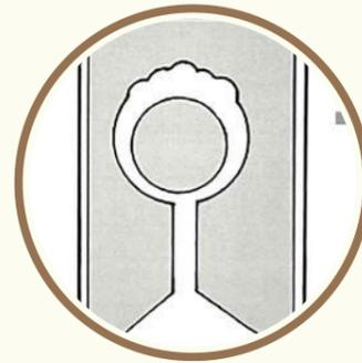
Una vez que la cera ha sido completamente eliminada, el molde se precalienta para evitar choques térmicos. Luego, se vierte el metal fundido (oro, plata u otros metales) en el molde a través del canal de alimentación. El metal llenará el espacio dejado por la cera.
