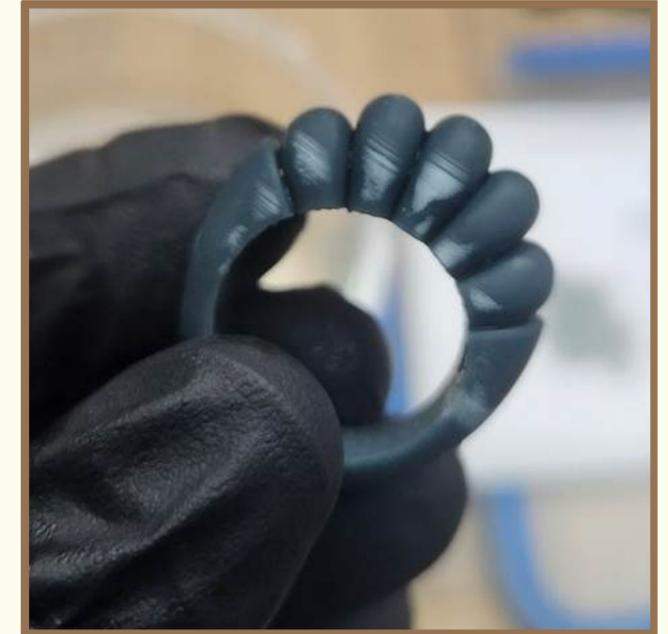
Se retiran del alcohol y se sopletea con aire y se vuelven a colocar en alcohol.
