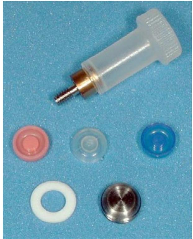
Figura 27-19. Broche Locator. Tubo metálico para roscar al implante sujeto con su portador descartable; partes elásticas de resina rosa, incolora y celeste; receptáculo metálico para fijar a la base de la prótesis; anillo para evitar el corrimiento del acrílico dentro del broche durante su fijación con acrílico autocurable.
