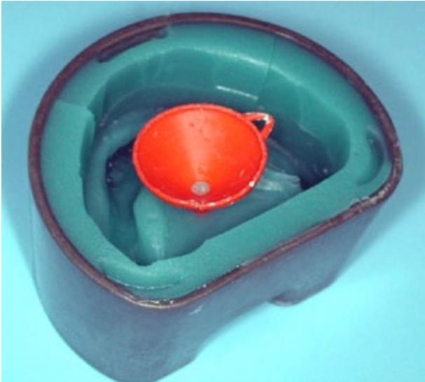
Figura 22-09. Preforma del bebedero colocada en la impresión de gelatina.
