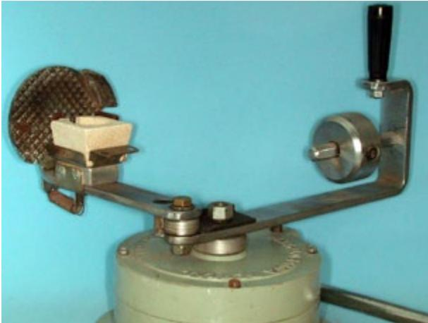
Figura 22-13. Centrifuga a resorte para colado de esqueletos de ACr-Co.
