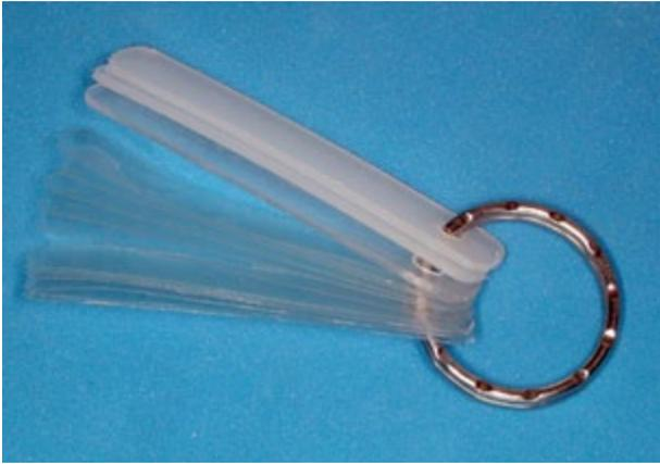
Figura 19-05. Calibrador de láminas de acetato.
