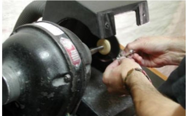
Figura 22-18. Pulidora de mesa para el pulido brillante.
