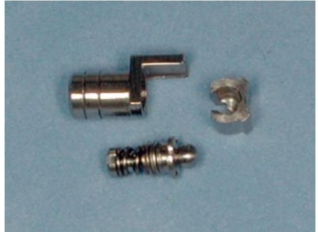
Figura 27-08. Atache ASC-52 con el mecanismo de la patrix fuera de su caja.
