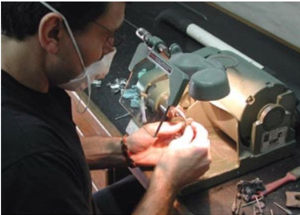
Figura 22-15. Amoladora de mesa de alta velocidad para cortar y desbastar el colado de ACr-Co.
