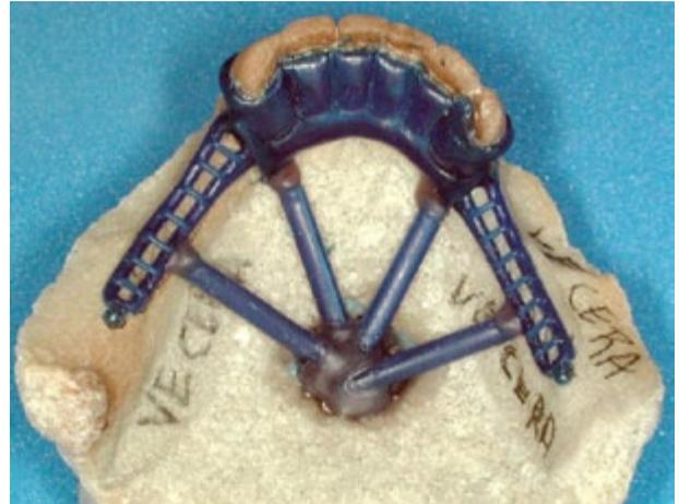
Figura 22-12. Se colocaron en el encerado los bebederos para la entrada del metal fundido.
