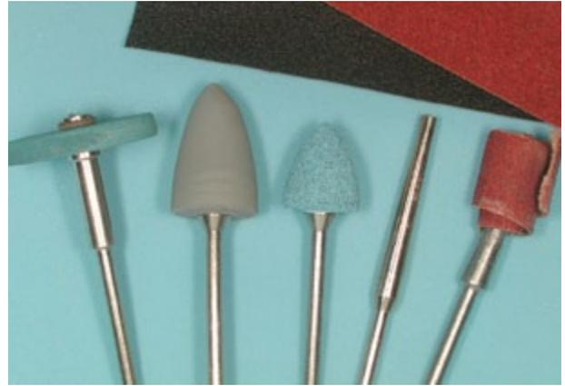
Figura 24-22. Instrumentos rotatorios para alisar las bases, de izquierda a derecha: rueda de goma, conos de goma, mandril ranurado para lija, mandril con la lija montada. Arriba: tiras de papel de lija, común para madera y lija al agua.
