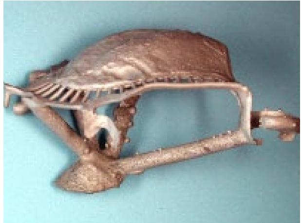
Figura 22-14. Colado de ACr-Co recuperado del revestimiento y arenado.
