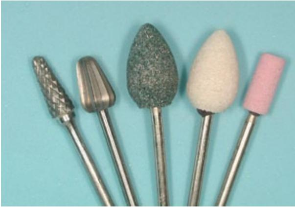
Figura 24-21. Instrumentos rotatorios para eliminar excesos y retocar la forma de las bases, de izquierda a derecha: fresa de acero de corte cruzado, fresa de acero de corte liso, piedra verde-grano grueso, piedra blanca-grano fino, piedra rosa-grano fino.
