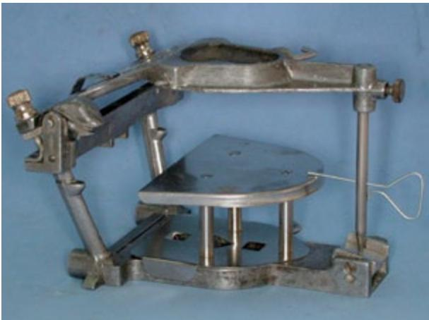
Figura 17-07. Articulador New Simplex con platina de montaje para el modelo superior y con pin incisal para ubicación del punto interincisivo.
