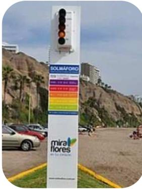
*"El Solmáforo es un equipo diseñado para medición de radiación del tipo U-VB, la más peligrosa para la piel. La medición se efectúa mediante sensores ópticos y filtros UV. El sensor entrega la intensidad de la radiación UV mediante un código de colores"<sup>1</sup>*
