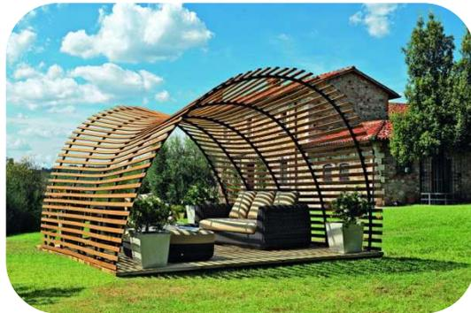
Esta pérgola diseñada por la firma *Unopiú*, denominada “Wave” (ola) consta de cimbras en tubo de hierro galvanizado pintado con polvos de color grafito; estribos para la fijación en el suelo (se necesitan tacos ofrecidos por separado); listones de pino nórdico impregnado de 15
