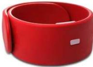
La pulsera a prueba de agua **UveBand** posee un sensor UV integrado el cual mide la radiación ultravioleta cada 3 segundos. Con un procesador incorporado realiza un seguimiento de monitoreo sobre la exposición al sol y vibra indicando la necesidad de reaplicar bloqueador solar. Para su funcionamiento debe encenderse a partir de la primera aplicación de filtros sobre la piel. Actualmente se encuentra en fase de desarrollo y fabricación, su precio proyectado será de \$11 dólares.<sup>14</sup>
