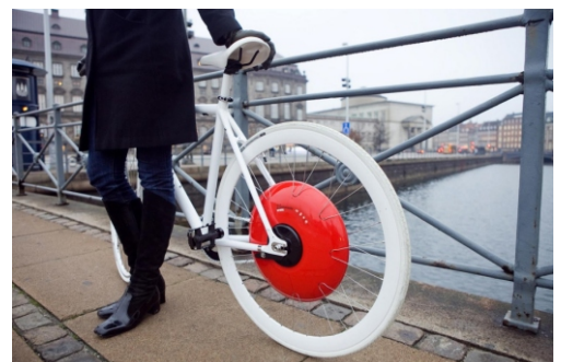
▼ Copenhaguen wheel. Rueda/motor para bicicleta convencional de tecnología avanzada
