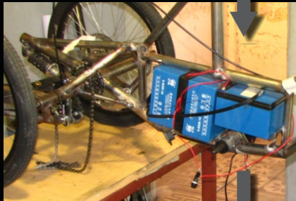
Instalación de baterías
