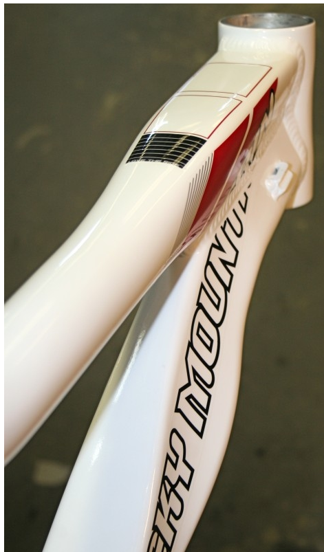
▲ Ejemplo de cuadro realizado en aluminio con piezas hidroformadas y posteriormente ensambladas por soldadura.
