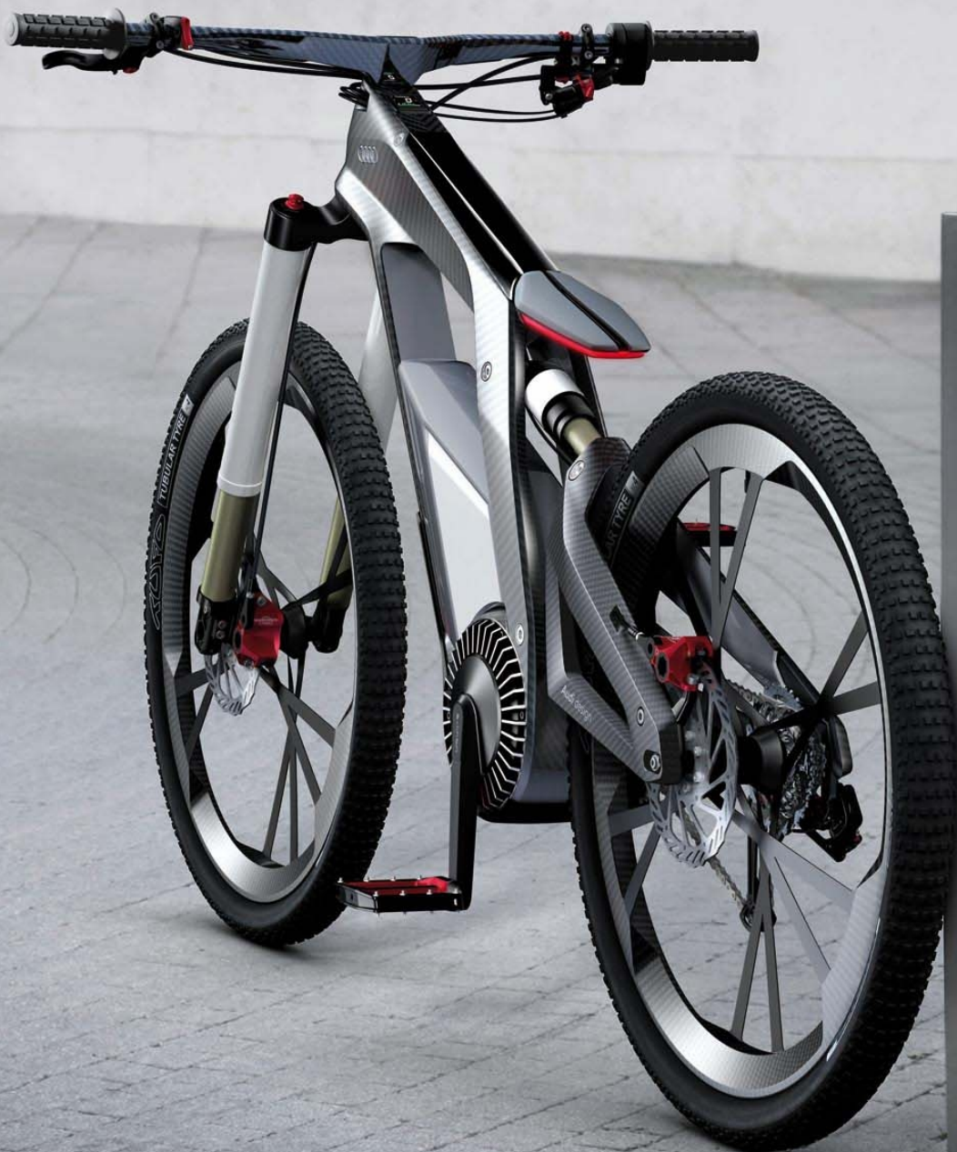
▲ E-Bike AUDI 2012 Construida en fibra de carbono. Excelente desempeño con la más alta tecnología. Luces LED computadora a bordo con reconocimiento de piloto y bloqueo. Alcanza los 80km/h.
