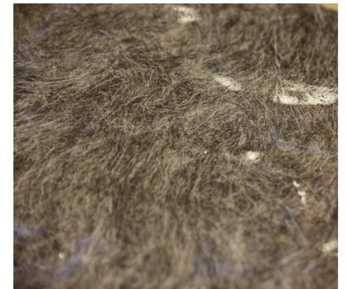
se continuó ensayando con diferentes variantes en cuanto a las proporciones de cantidad de almidón de maíz y pelo bovino en la mezcla. Se realizó una serie de muestras en las cuales se fueron incrementando dichos parámetros, partiendo de igual proporción de almidón y agua hasta cuatro veces la cantidad de agua que almidón de maíz.
