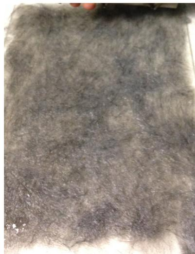
La primer muestra realizada con dicha técnica se realizó con una concentración de 50g de almidón de maíz por cada 300ml de agua y 4.2g pelo bovino.
