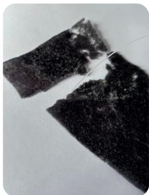
La fuerza aplicada con la muestra en caliente hizo que la misma se quiebre. Se considera que esto se debe a el alto grado de flexibilidad y debilidad que adquiere el material luego de someterse a altas temperaturas.
