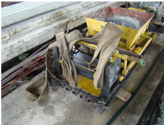
Máquina de extrusión que corre por la mesa de chapa. Se aprecia en la parte inferior del frente los caños cilíndricos que ahuecan la losa
