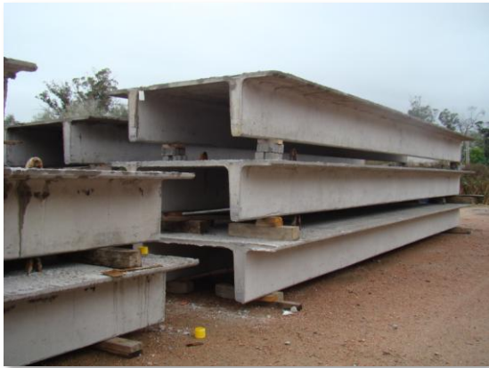
Paneles Doble T para entrepisos en la planta de producción de Flasur
