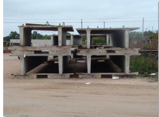
Paneles doble T en espera para su traslado
