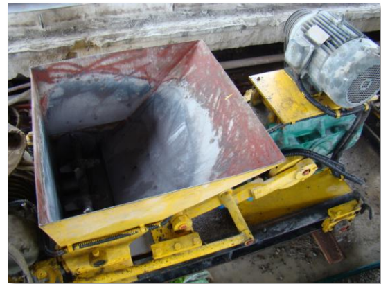
Parte superior de la máquina de extrusión donde se va volcando el hormigón durante el proceso de producción
