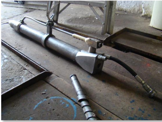
Gato hidráulico utilizado para tesar los torones de los paneles en la planta de producción de Flasur
