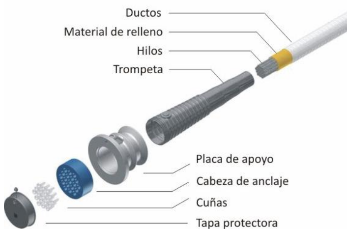
Esquema de componentes del sistema CONA de BBR
