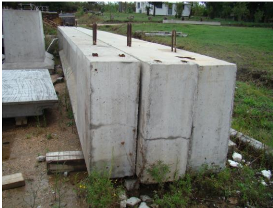
Vigas rectangulares en el banco de vigas pretensadas de Flasur
