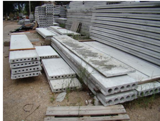
Losas huecas en la zona de acopio de la planta 2 de Hopresa
