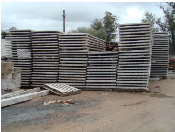
Losetas prelam en la zona de acopio de la planta II de Hopresa
