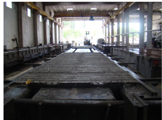
Terminación rugosa de un panel doble T a utilizar como entrepiso
