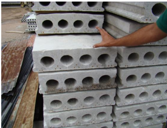
Losas huecas en la planta II de producción de Hopresa
