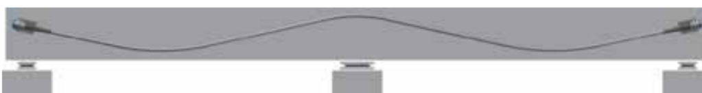
Esquema de cables en hormigón postesado
