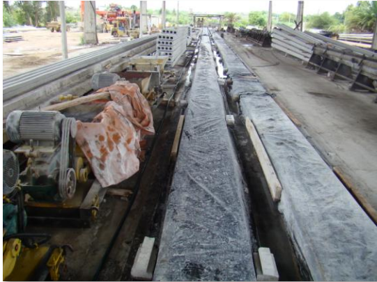
Producción de dos mesas de losas huecas tapadas con nylon. Se puede observar que la losa de la derecha está más seca que la central ya que fue realizada el día anterior
