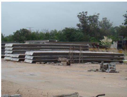
Paneles Pi en el área de estiba de la planta de Flasur
