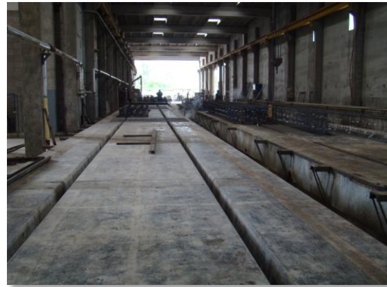
Moldes para paneles doble T en planta de producción de Flasur
