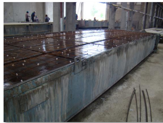
Molde de un panel Pi (se aprecia su curvatura)
