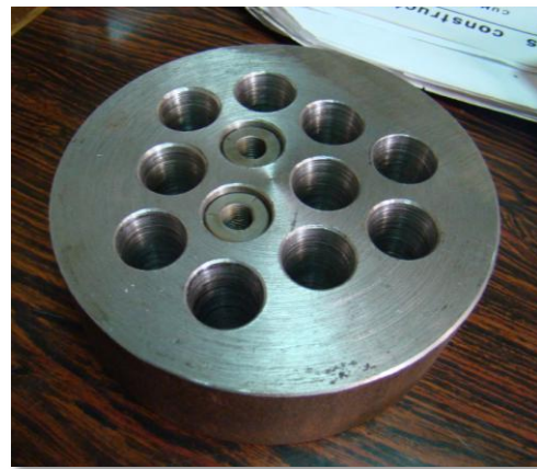
Sistema de cuñas multi-torón en fábrica Hopresa
