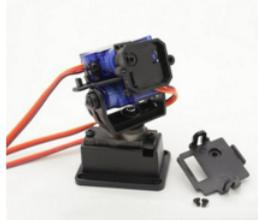
Figura 4.4: Soporte con servomotores
