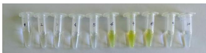
**Figura 29.** Fracciones (500  $\mu$ L) eluidas de la PD-10 con agua miliQ.
