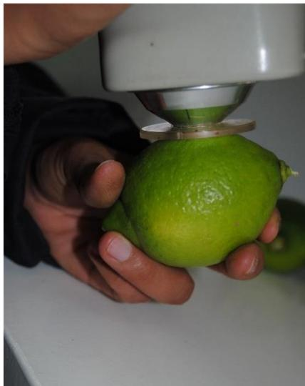
Figura 5. Medición de color con colorímetro (PCE-TCR 200)
