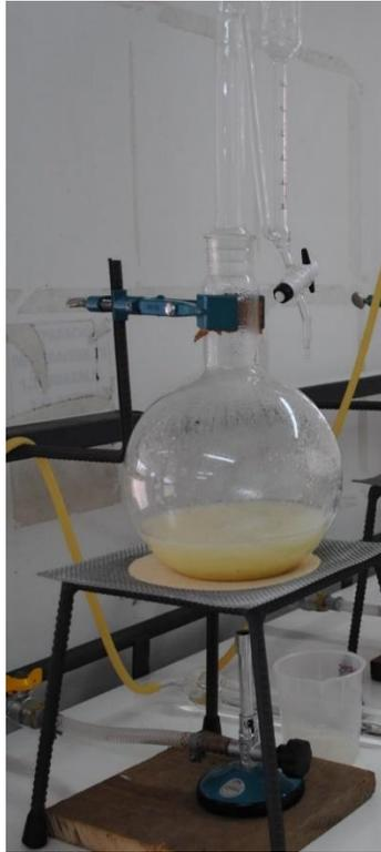
Figura 3. Destilador utilizado para la determinación de aceites por el método Clevenger
