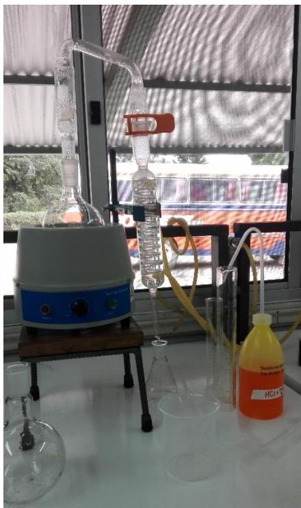
Figura 4. Destilador utilizado para la determinación de aceites por el método Scott
