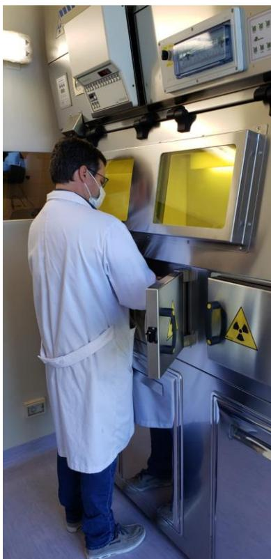
Figura 3.2. Radiomarcacion de anticuerpos en “celda caliente” del CIN.
