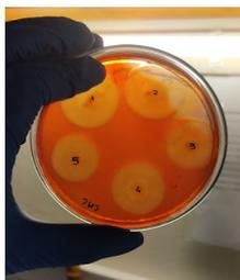
**Figura 1:** Detección en medio sólido de un cultivo bacteriano de halos de degradación de CMC revelado con solución de Rojo Congo indicativo de actividad hidrolítica.
