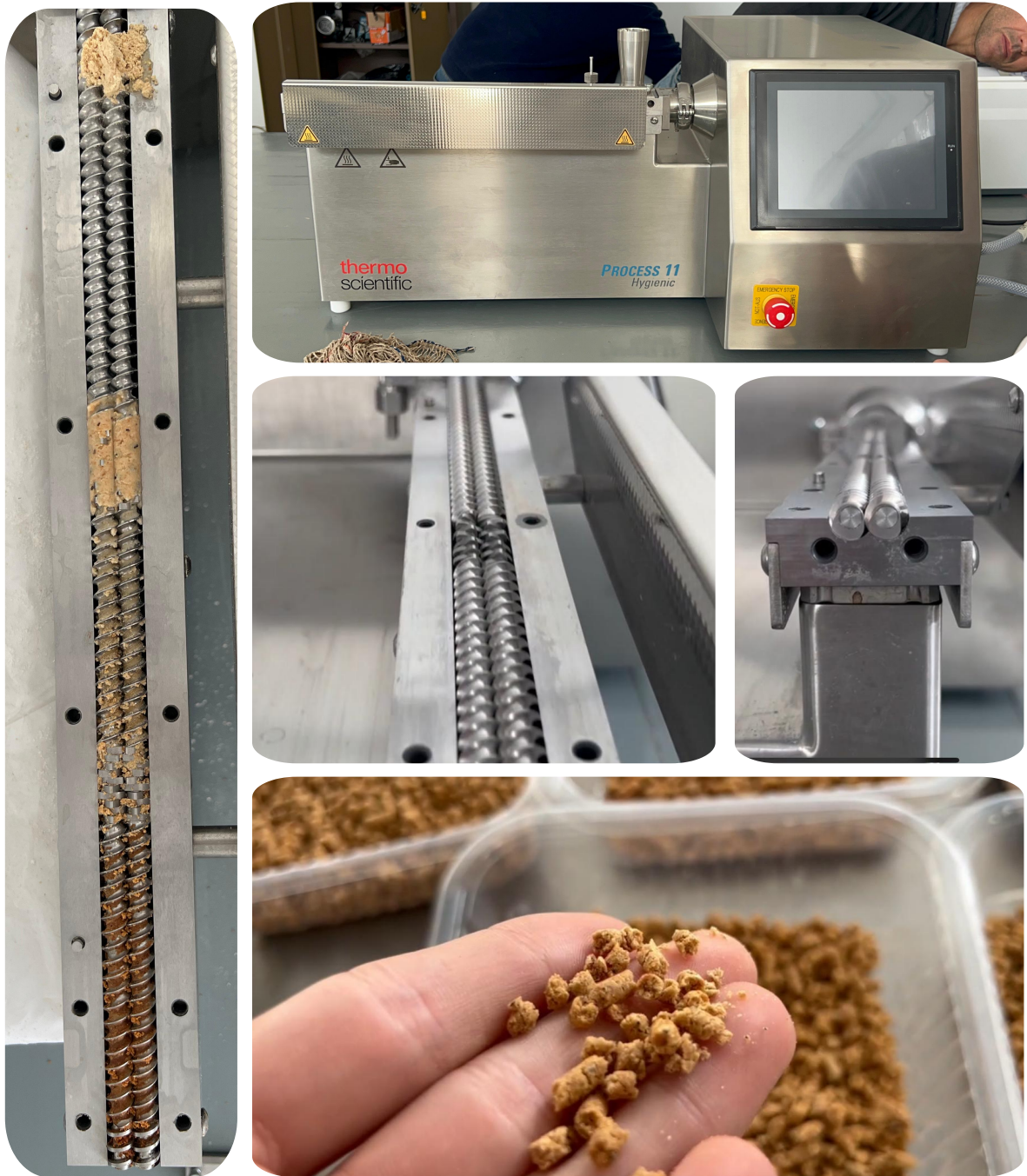
Figura 3.6: Compilado de imágenes del extrusor preparado para su uso y posterior al mismo, así como del producto final.
