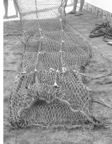
Fig. 63 – Túnel reforzado Longitudinal y Transversalmente
