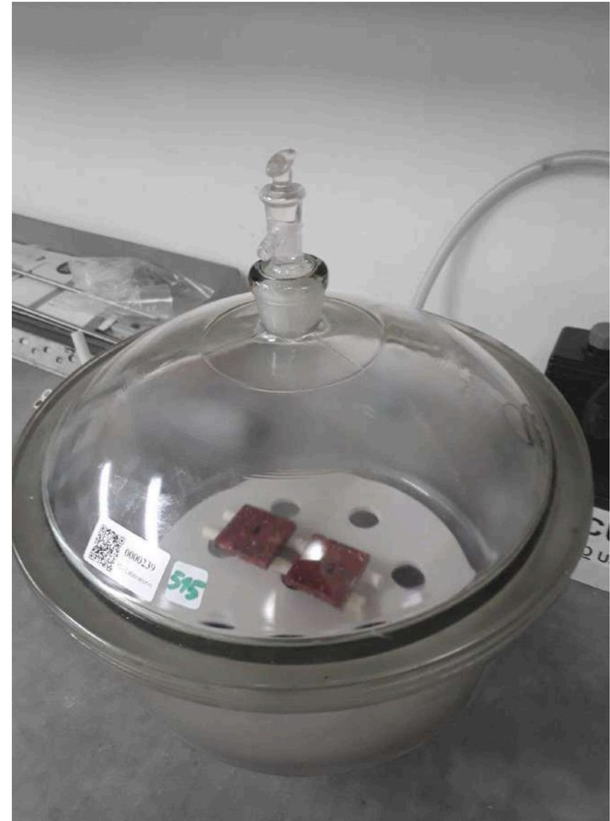
Figura 18. Probetas en el desecador de LabIC.
