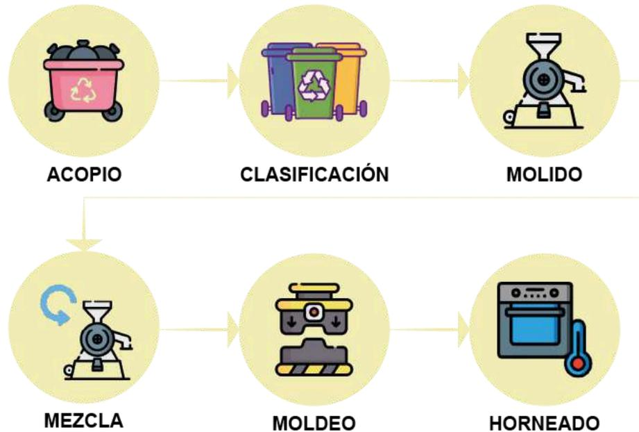
Figura 10. Adaptación del proceso productivo para la fabricación de RESIL.
