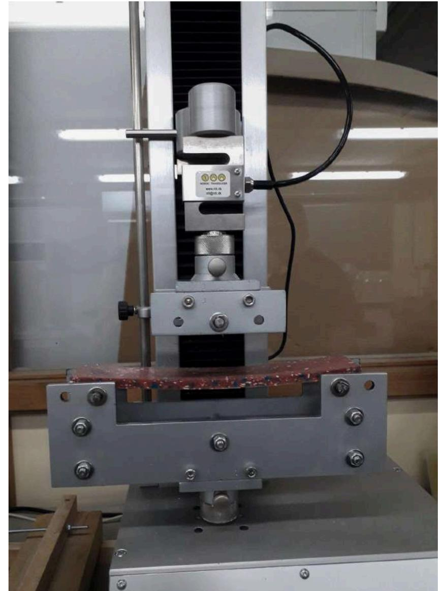
Figura 20. Ensayo de flexión estática en LabIC.
