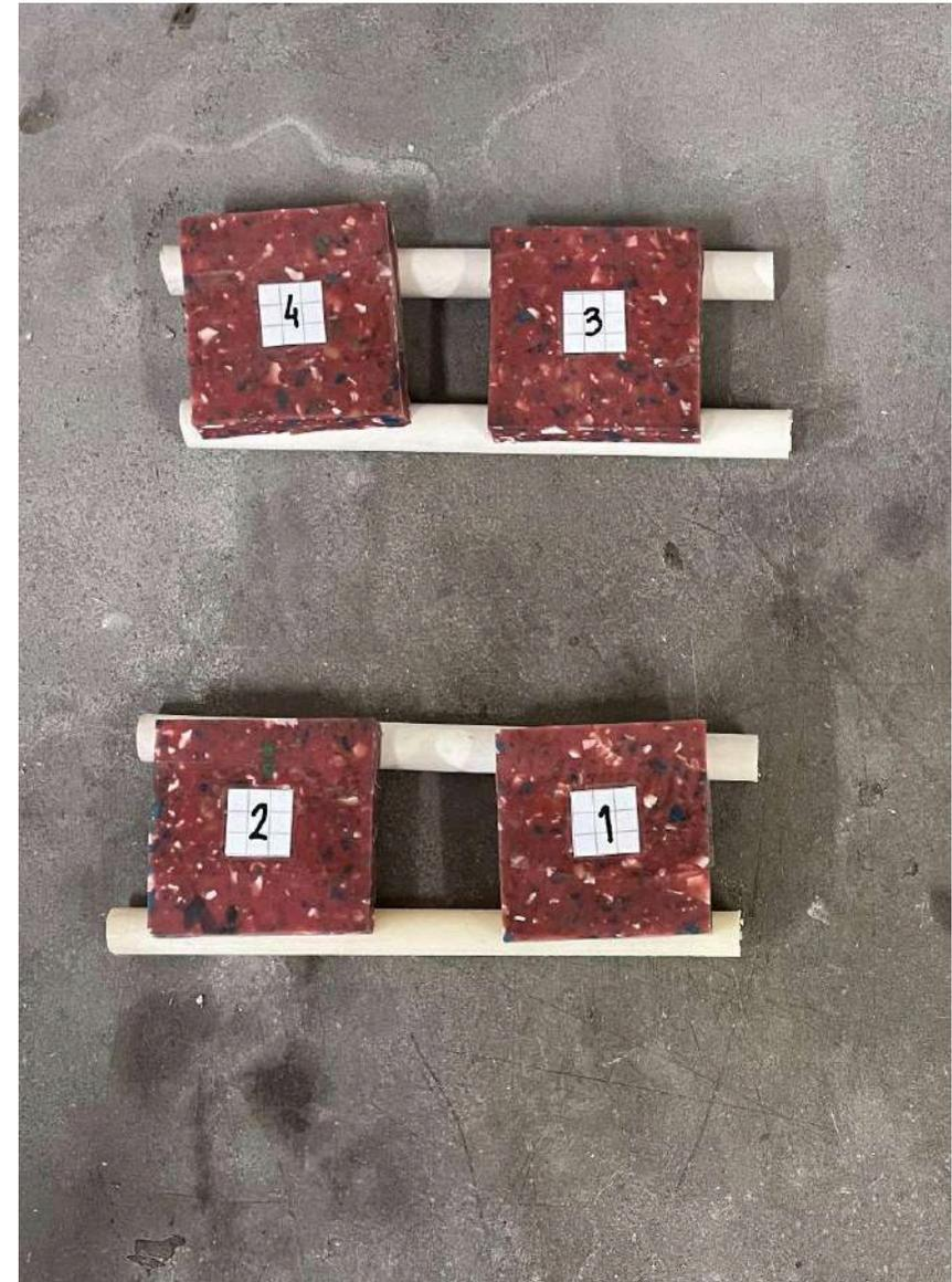
Figura 16. Probetas realizadas para el ensayo de densidad.
