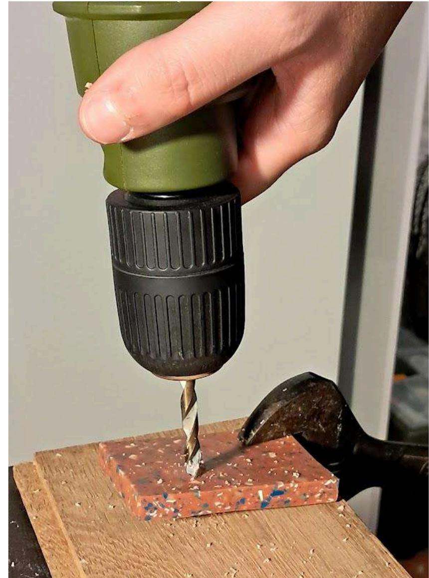
Figura 24. Prueba de taladrado del material.
