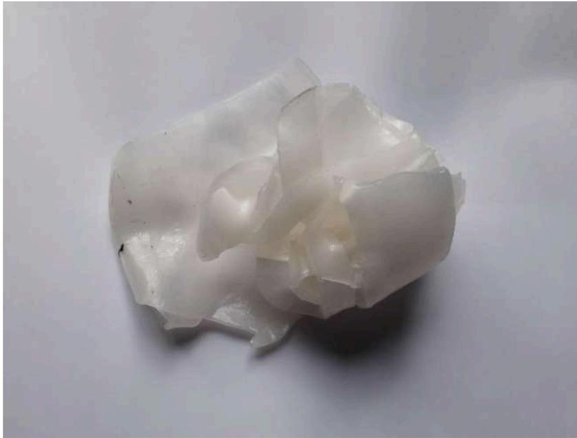
*Figura 12. Silicona virgen previo a incorporarse en el molino para mezclarse con los gránulos de silicona reciclada y molida.*
