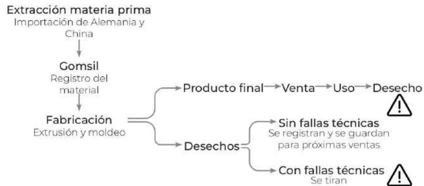
**Figura 4.** Ciclo de vida de los productos de silicona fabricados en Gomsil.
