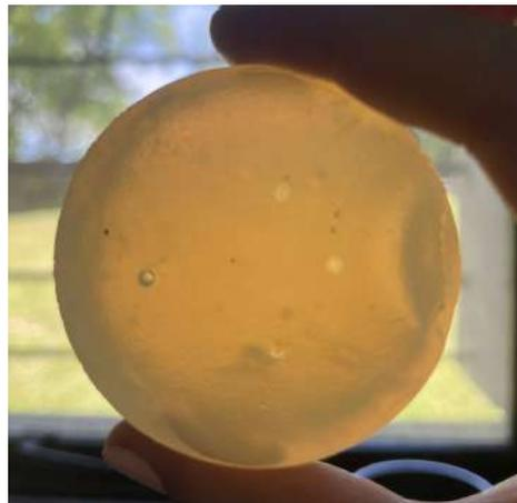
Figura 14. Fantoma con dos manchas blancas y dos perforaciones, consecuencia de irradiación de 300 mV por 25, 30, 35 y 40 segundos. ( $23.00 \pm 0.57$ ,  $25.00 \pm 0.41$ ,  $27.00 \pm 1.53$  y  $30.00 \pm 3.4$  W de potencia máxima)
