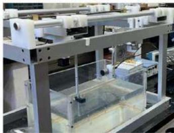
Fig. 1. Sistema de mapeo de ultrasonido.
