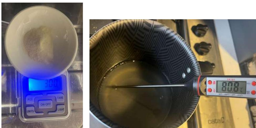
Figura 5. Procedimiento de producción de fantomas. Medición de Agar 3g. Calentamiento de Agar y agua hasta punto de fusión de Agar, más de 80 °C.
