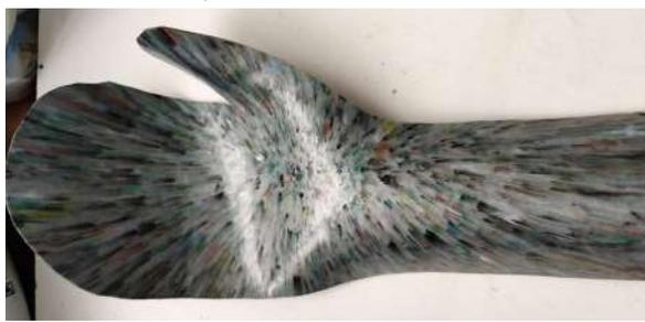
Fig. 33. Férulas realizadas con HDPE reciclado
