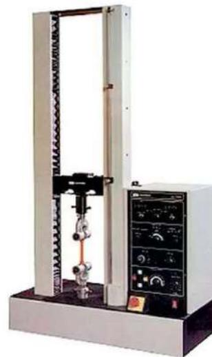
Fig. 36. Máquina INSTRON MODELO 1011 para hacer ensayo de flexión
