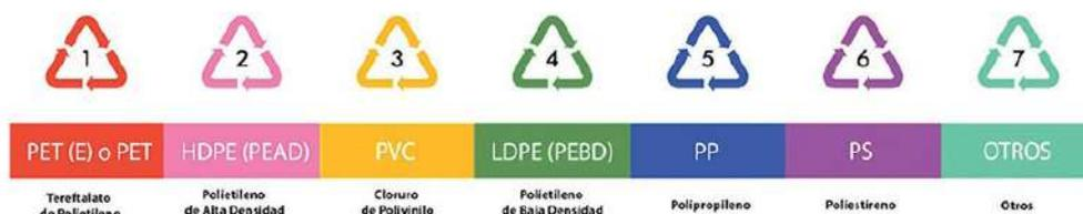
Fig. 9. Tipos de plásticos y su identificación
