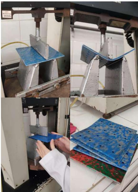
Fig. 38. Ensayo de flexión a tres puntos de muestras en HDPE reciclado (Anexo2)
