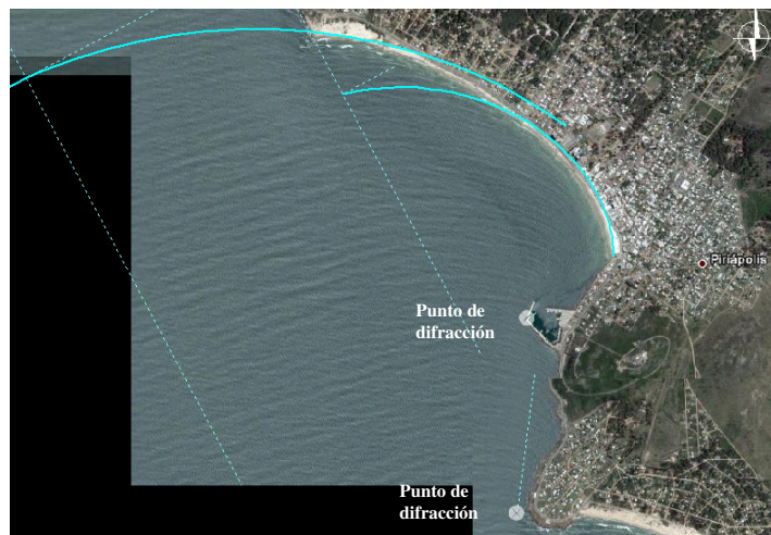
Figura 5.- Parábola de equilibrio estático del tramo de costa en estudio, con punto de difracción en la punta Imán y en el puerto.
