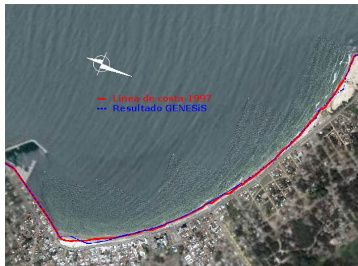
Figura 8.- Resultados del modelo GENESIS. Posición inicial y final de la línea de costa para el periodo 1997-2004.
