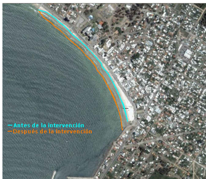
Figura 10.- Posición de la línea de costa, antes y después de la solución propuesta.
