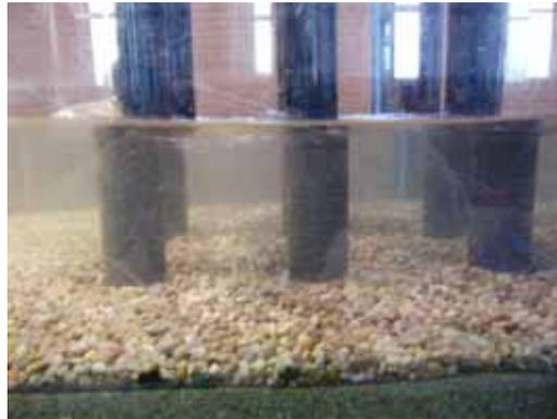
**Figura 4.-** Sobre-elevación y aspecto de la superficie libre registrada durante modelación física.
