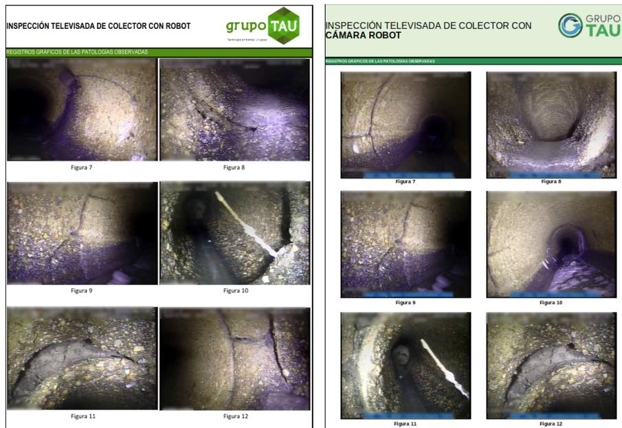
Figura 4.17: Reporte de defectos brindado por DICA & Asociados (izquierda), y generado por el sistema (derecha). La figura de la izquierda provista por DICA & Asociados.
