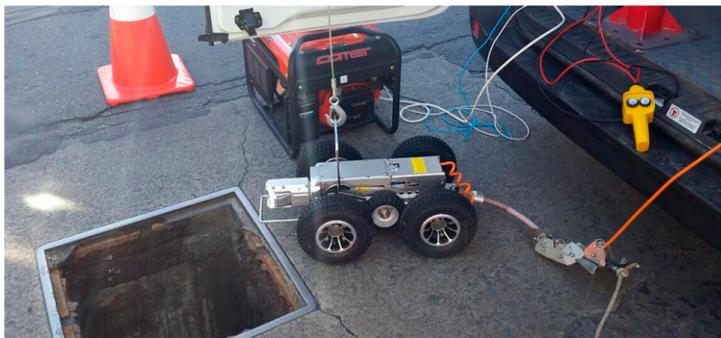
Figura 4.4: Robot próximo al ingreso en la tubería. Figura extraída de (Asociados, s.f.).
