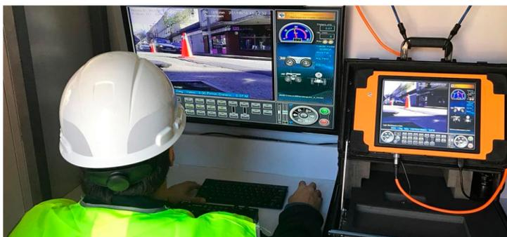
Figura 4.5: Técnico operando el dispositivo robótico desde la superficie. Figura extraída de (Asociados, s.f.).
