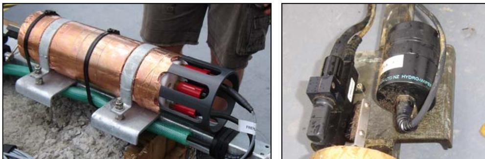
**Figura 4.-** Equipo de medición de temperatura, conductividad y presión (panel izquierdo) y equipo de medición de turbidez (panel derecho).
