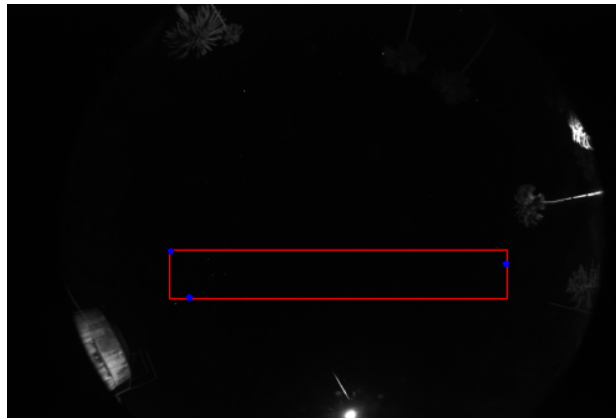
Figura 15: Este es un ejemplo todavía más evidente del mal funcionamiento del tracking de AUTOBOL en las cámaras ASI, vemos la traza del bólido en la región inferior de la imagen. Sin embargo, ninguno de sus puntos es registrado. Las estrellas son lo más brillante en cada frame enmascarado.
