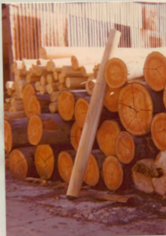
Fig. 2.- Núcleos resultantes del debobinado de las trozas.-
