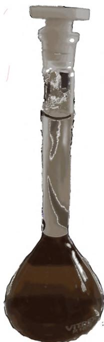
Fig. 2.6. **Solución de GO22** La matraz contiene la solución de GO22 y agua destilada a analizar, posteriormente se colocó parte de la solución en una cubeta de cuarzo para realizar el análisis UV-Vis.
