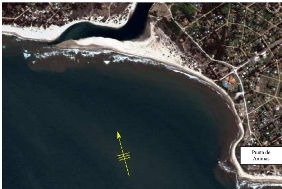
**Figura 4.-** Dirección de la resultante del flujo de energía dado por el clima de olas
