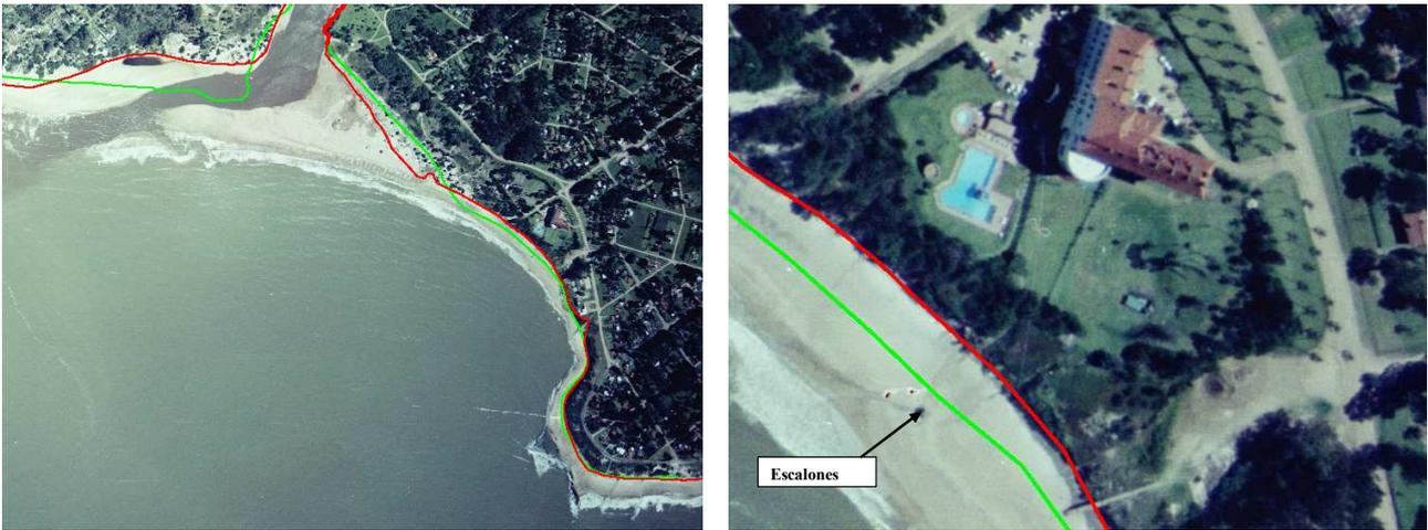
**Figura 6.-** Evolución de la línea de costa en la zona de estudio. Año 1980 (verde). Año 2001 (rojo y foto). Vista general del tramo (izquierda). Acercamiento en el tramo central (derecha).
