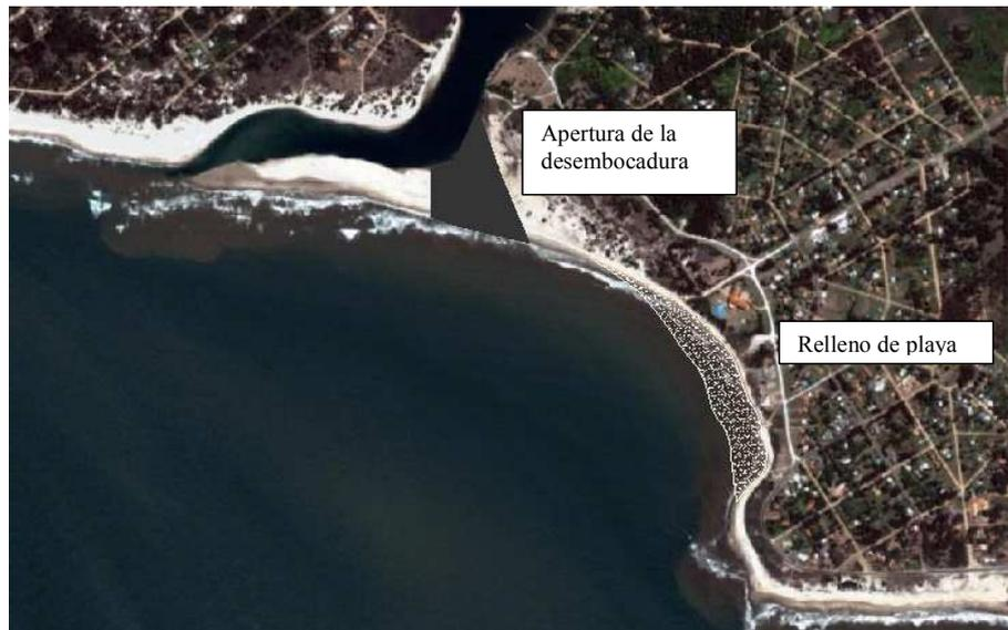
**Figura 10.-** Solución propuesta para la estabilización de la costa
