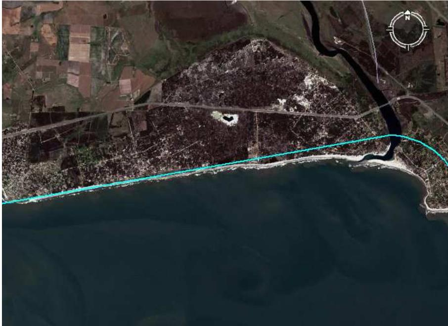
**Figura 5.-** Parábola de equilibrio del tramo de costa en estudio, con punto de difracción en la punta de Solís, obtenida con el Sistema de Modelado Costero<sup>1</sup>.
