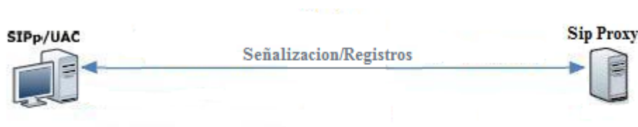
Figura 4. 7 – Esquema 1 de prueba de registros a SIP Proxy
