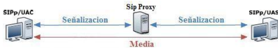
Figura 4. 5 – Esquema 1 de prueba de llamadas a SIP Proxy
