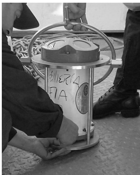
Figura 4.- Imagen del ADCP en la cubierta de la embarcación durante la preparación para su fondeo.
