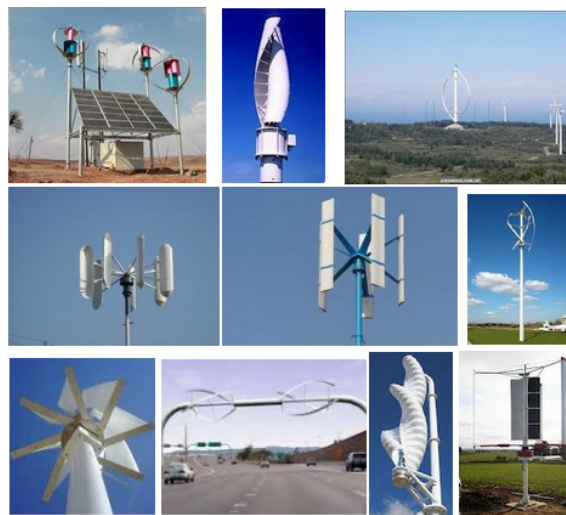
Figura 1.5: Aerogeneradores de eje vertical. [30]
