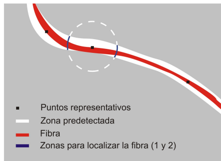
Figura 3.32: Intersección con la zona predetectada
