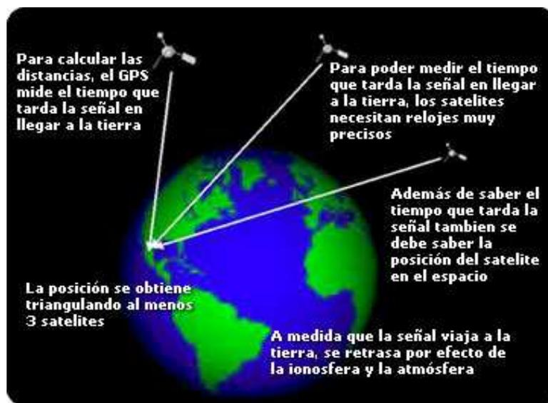
Fig 5.8: Procedimiento del receptor GPS
