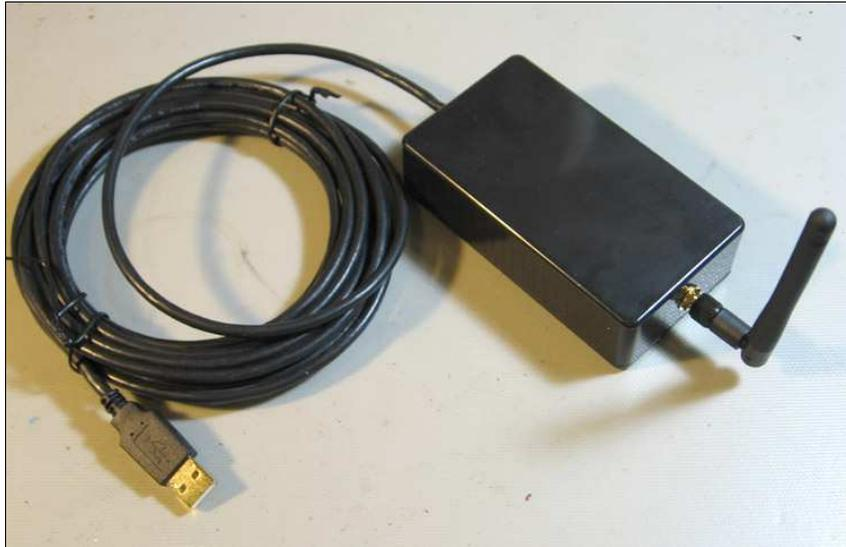
**Figura 4.2: Prototipo de active antenna**
