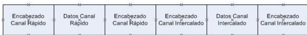
Fig-7.4: Estructura de cada trama de datos incluyendo ambos canales; rápido e intercalado.
