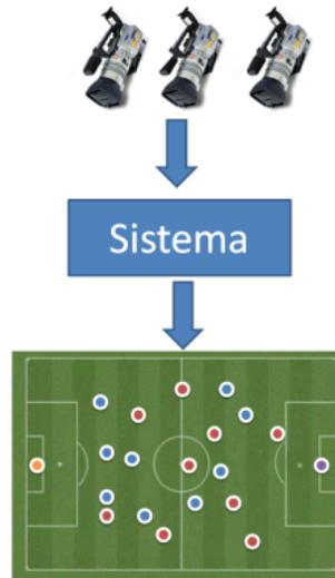
Figura 1.5: Descripción del sistema. La entrada es un conjunto de videos, y la salida es la posición y velocidad de cada uno de los jugadores y árbitros.
