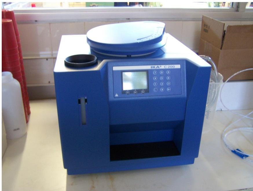
*Figura 26: Bomba calorimétrica utilizada (LATU).*
