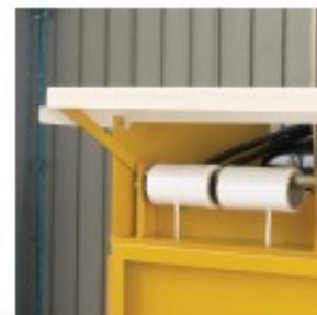
Los rollos de correas se remplazan fácilmente en la parte delantera de la máquina.
