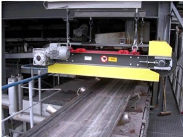
***Figura 45: Imanes permanentes colocados sobre las cintas ([www.goudsmit-magnetics.nl](http://www.goudsmit-magnetics.nl)).***
