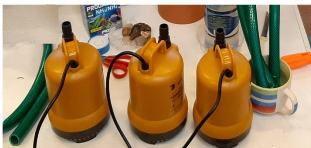
Figura 8. Bombas de agua; Foto tomada durante el armado del sistema de bombeo de agua.
