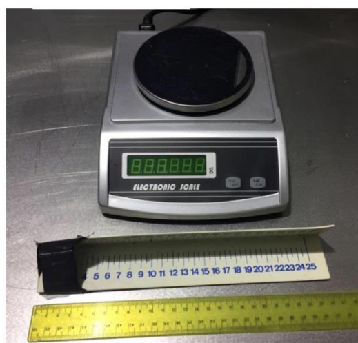
Figura 12. Balanza de precisión e ictiómetro utilizado para realizar los muestreos de peces.
