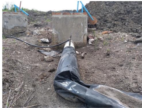
**Figura 13.** Pitot inserto en tubo a la salida de una compuerta en riego con mangas en caña de azúcar.
