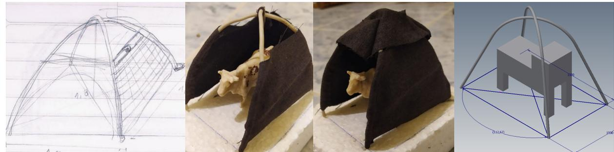
**1.** Partiendo de los primeros bocetos se pasó a realizar acercamientos a la tridimensionalidad, mediante pequeños modelos a escala y dibujos 3D en Inventor. Las primeras pruebas se hicieron con arcos semi-circulares, cruzados. Se observó que esa era una forma que no acompañaba bien la forma del ternero y se desperdiciaba espacio en alto y le faltaba espacio en largo. Por eso se optó por probar con una forma alargada, prismática.
