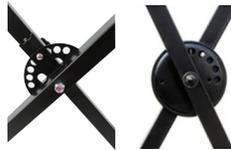
Se tranca y regula mediante disco con agujeros que actúan de guía para que se introduzca un pernito que fija los dos tubos en una posición determinada.
