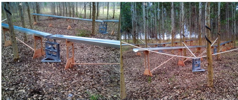
**Figura 3.** (a) Canaletas dispuestas en grupos de 2 tramos y registradores de cangilón, parcela AGd (año 2019); (b) Collarines de goma y tuberías de PVC que conducen el flujo de 5 árboles hacia el registrador de cangilón, parcela NEg (año 2018).
