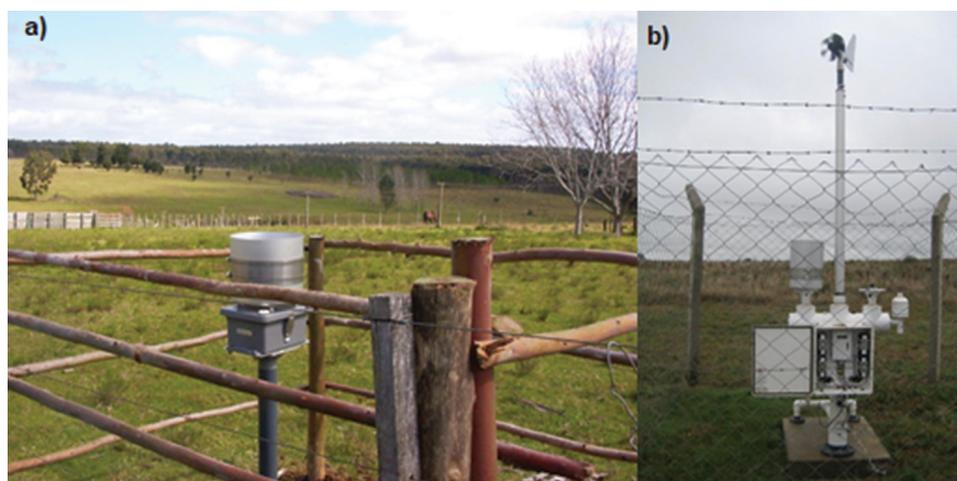
**Figura 1.** (a) Pluviógrafo para registro de la precipitación total incidente próximo a la parcela SJg (año 2005); (b) Estación meteorológica próxima a la parcela NEg (año 2015).
